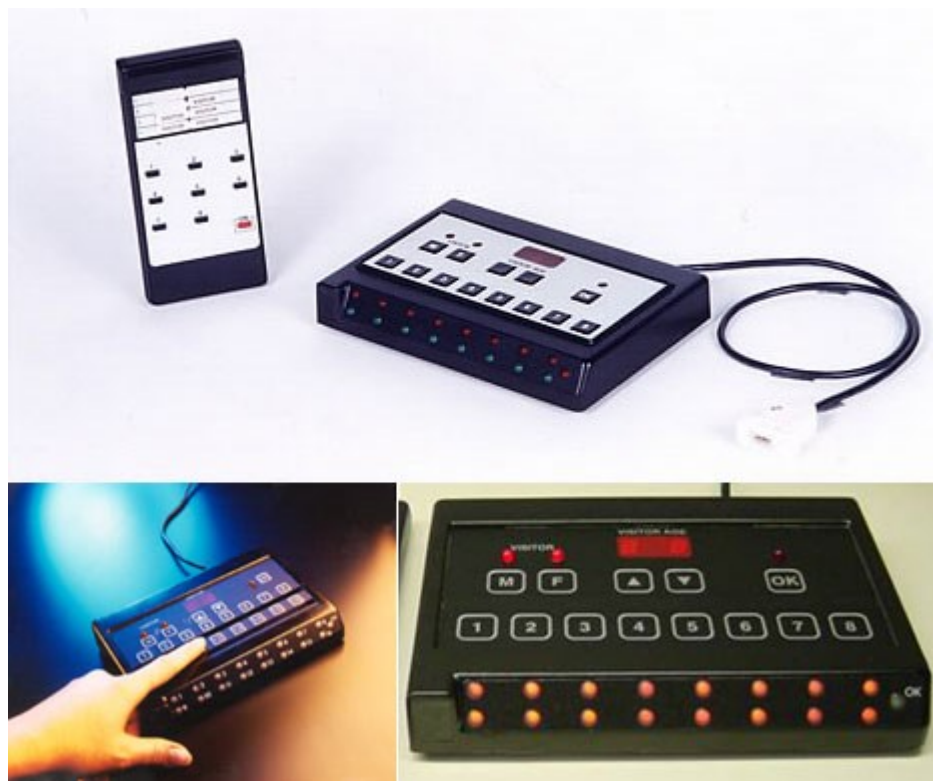
Uređaj za merenje gledanosti - pipmeter
